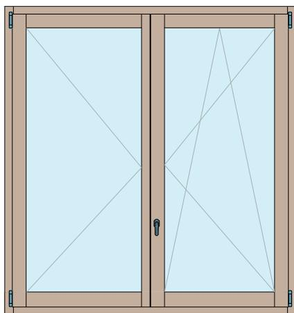
Il sistema EASY ZERO come su tutte le tipologie monta anche le cerniere a scomparsa rendendo il sistema pulito in prospettiva. Questa tipologia di cerniere permettono un' apertura massima dell' anta di 110°.
