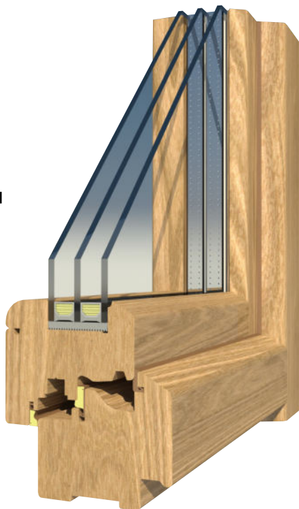
Vetro di serie montato sugli infissi "Zeus Plus" 33.1+14argon+4be+14argon+33.1 Top1 canalina calda
